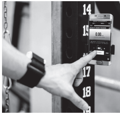
Figuur 3. Voorbeelden van linear position measurement (links) en position measurement (boven) instrumenten om de snelheid van de halterstang te meten.
